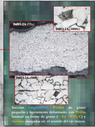
Sección longitudinal. Ferrita de grano pequeño y ligeramente deformado, con Perilita laminar en límite de grano (~0.1 - 0.2% C) y escorias alargadas en el sentido del eje mayor.
