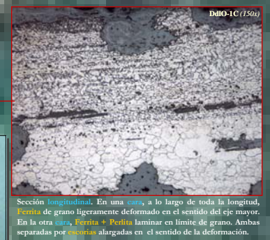
Sección longitudinal. En una cara, a lo largo de toda la longitud, Ferrita de grano ligeramente deformado en el sentido del eje mayor. En la otra cara, Ferrita + Perilita laminar en límite de grano. Ambas separadas por escorias alargadas en el sentido de la deformación.
