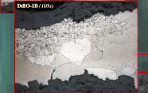
Sección longitudinal. Matriz ferrítica de grano grande y ligeramente deformado en el sentido del eje mayor, con escorias alargadas en la misma dirección.
